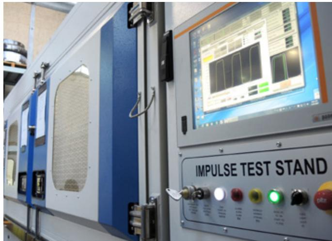
Banco per prova ad impulsi secondo norma SAE
