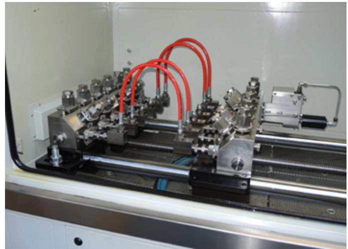
Banco per prova ad impulsi secondo norma SAE (interno)
