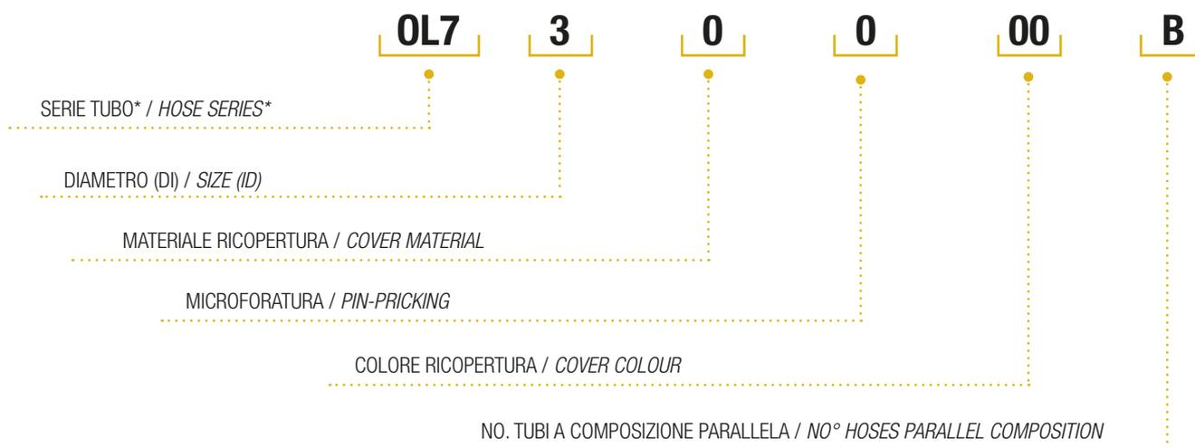
\* La SERIE TUBO specifica generalmente la tipologia di materiale utilizzato per l'anima interna e di conseguenza la compatibilità chimica del tubo. Per verificare la resistenza chimica a fluidi specifici vi invitiamo a consultare la relativa tabella sul sito: [www.zecspa.com/it/supporto-tecnico](http://www.zecspa.com/it/supporto-tecnico).
