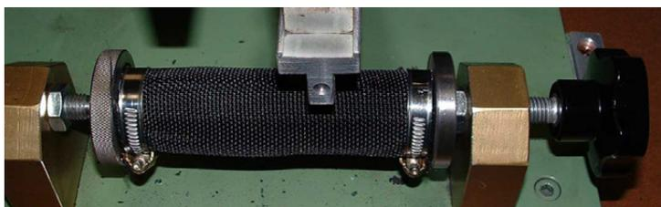
Fig. 1 - Prova di abrasione secondo UNI ISO 6945.
